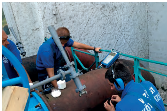
43. kép Mérés a KROHNE OPTISONIC 6300P típusú ultrahangos műszerrel
