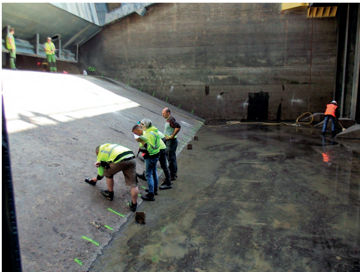
28. kép Kopóbeton vizsgálat a kettes számú duzzasztónyílásban
